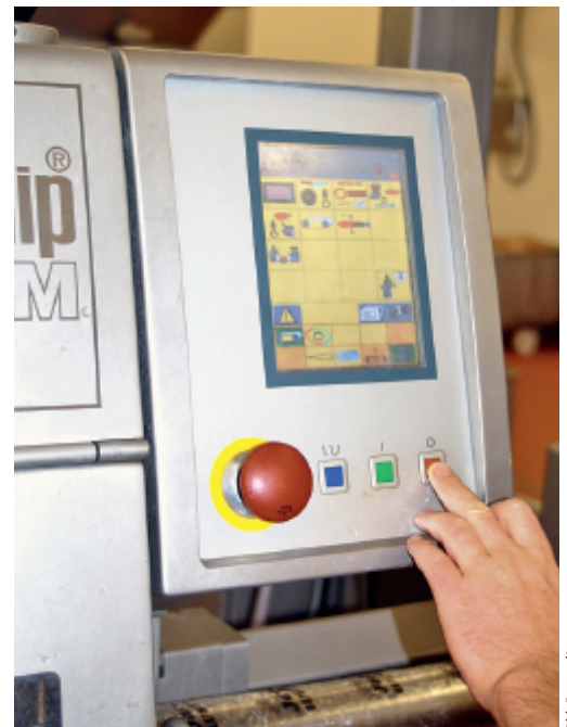
Die Rezepturen für die Produktion sind in der Easy-Touch-Steuerung hinterlegt, müssen nur noch über das Touchpanel aufgerufen werden.
