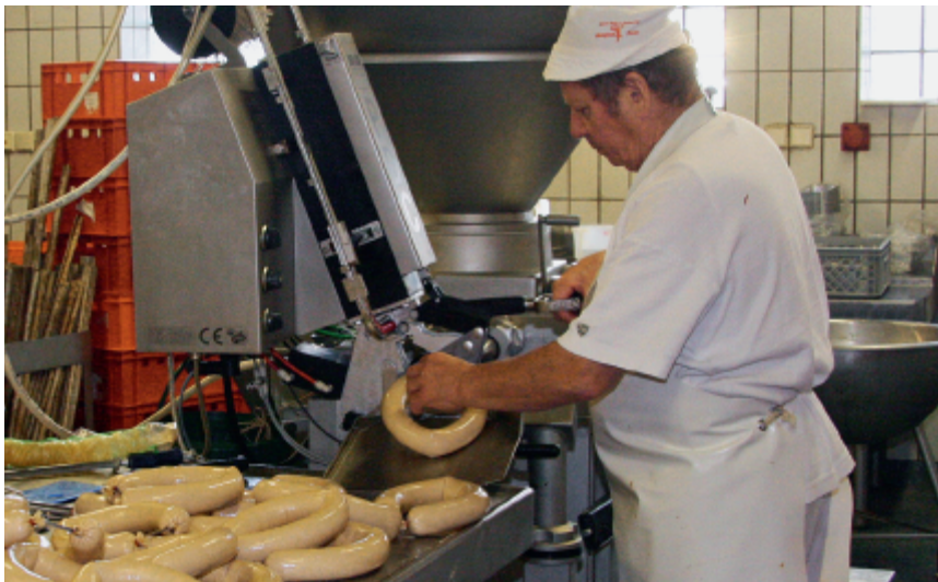
Der PDC 700 verarbeitet Kunststoff-, Faser-, Collagen- und Naturdärme in Kalibern bis zu 115 mm.
